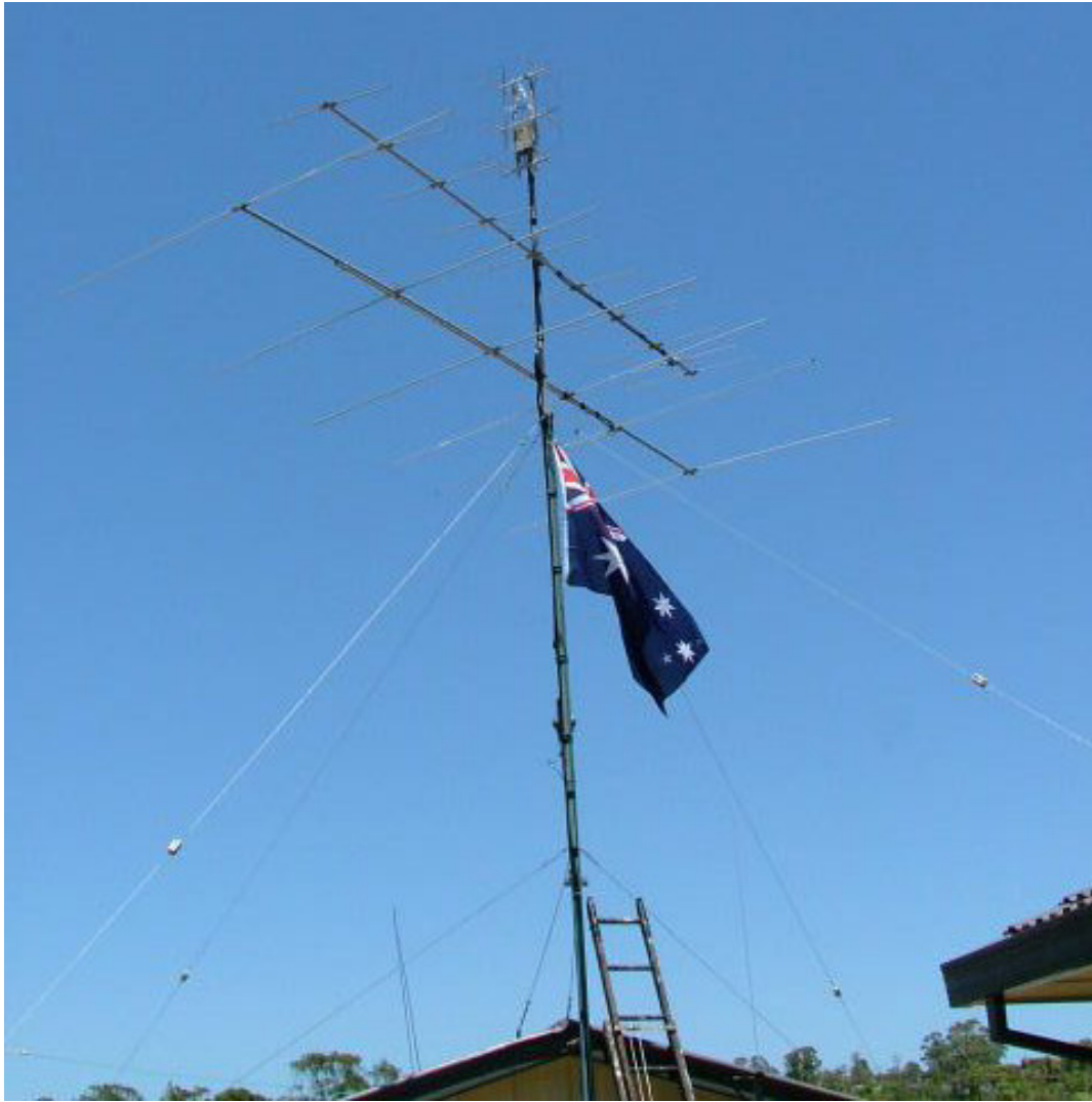
The final result, from top... 70cm 12 ele colinear, 2m 10 ele yagi, 6m 6 ele yagi
